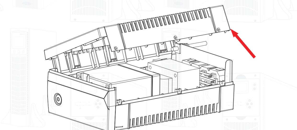
3. Осторожно приподнимите и установите аккумулятор вертикально, избегая контактов с электронными компонентами
