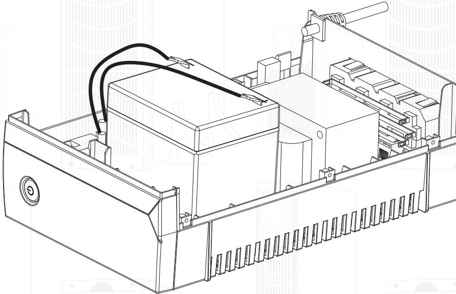
4. Аккуратно отсоедините клеммы от аккумуляторной батареи, избегая контактов с электронными компонентами. Обязательно проверьте корректность подключения катода и анода аккумуляторной батареи при подключении новой батареи
